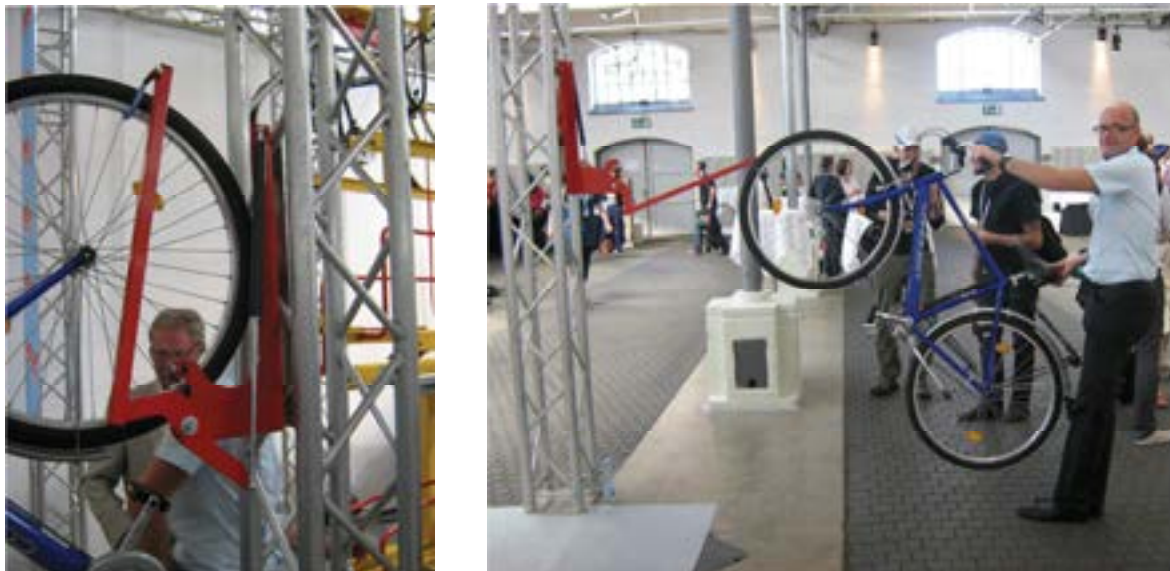
Crochet avec assistance pneumatique au levage
